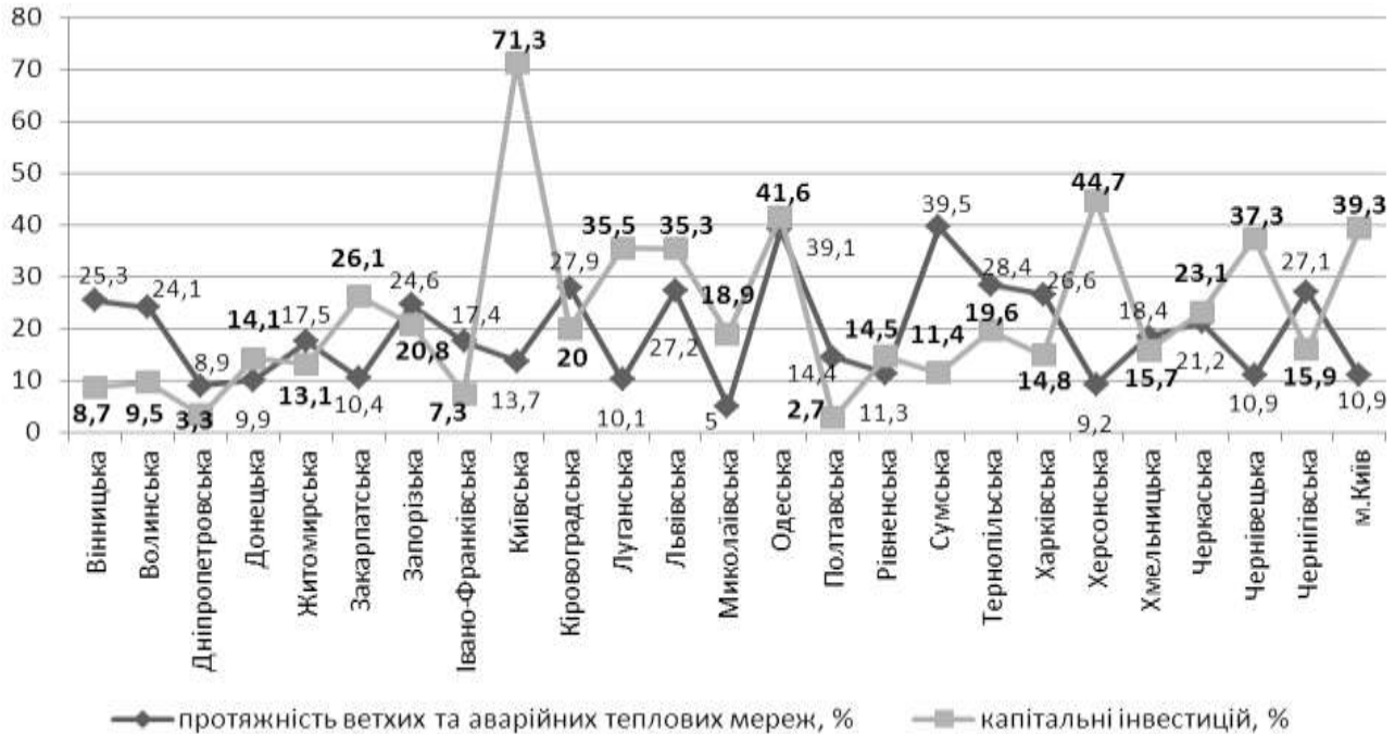
Рис. 1. Порівняльний аналіз частки ветхих та аварійних теплових і парових мереж з часткою капітальних інвестицій, які отримали підприємства постачання електроенергії, газу, пари та кондиційованого повітря за регіонами України (станом на 01.01.2017) (склав автор)
