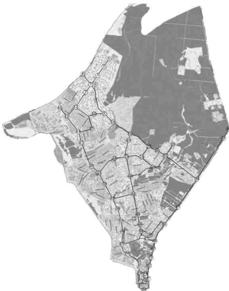
Рис. 3.3. Топологічна схема транспортної мережі з урахуванням центрів транспортних районів:
