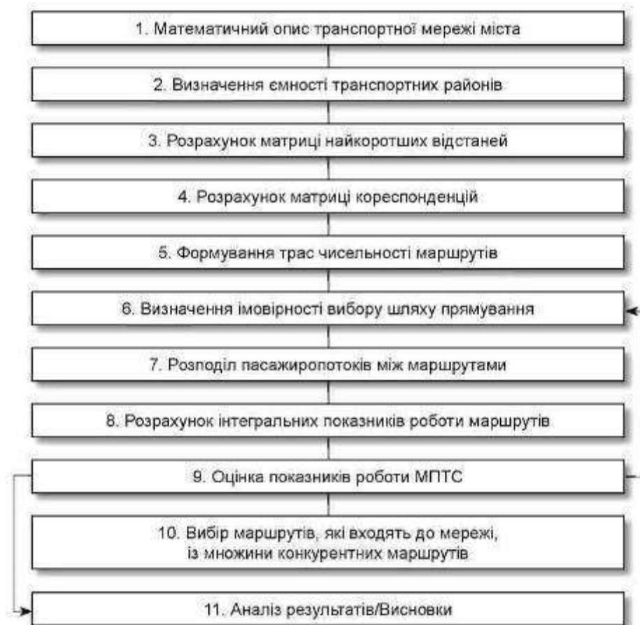
Рис. 3.2. Схема алгоритму моделювання функціонування маршрутної мережі міської пасажирської транспортної системи
