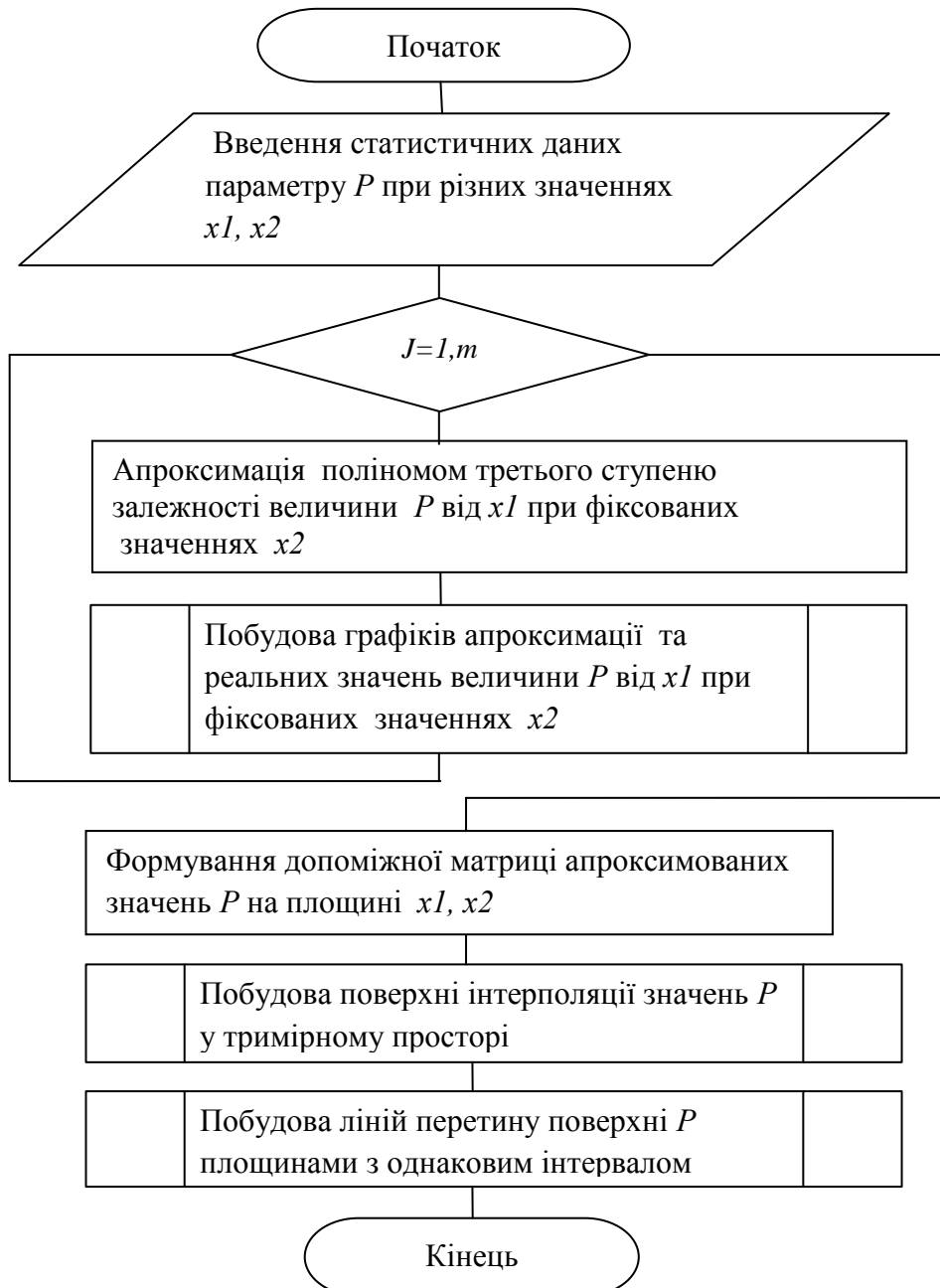
Рис. 5.11 – Алгоритм оптимізації проекту будівництва шляхом обрання максимального рівня реалізації ( P ) при різних значеннях двох впливових факторів ( x_1, x_2 ) [розроблено автором]
